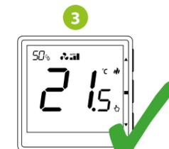
Der Regler ist für ein 2-Rohr-System konfiguriert.
