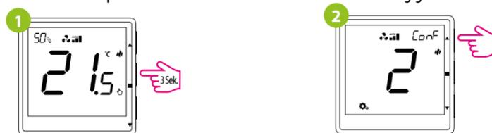
Verwenden Sie die  $\blacktriangle$  oder  $\blacktriangledown$  Taste, um zwischen den Parametern zu wechseln. Geben Sie den Parameter mit  $\equiv$  ein. Bearbeiten Sie den Parameter mit  $\blacktriangle$  oder  $\blacktriangledown$ . Bestätigen Sie den neuen Parameterwert mit der Taste  $\equiv$ .
