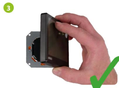
Schieben Sie die Vorderseite des Controllers über das Rückenteil. Schalten Sie die Stromversorgung ein. Der Controller ist betriebsbereit.
