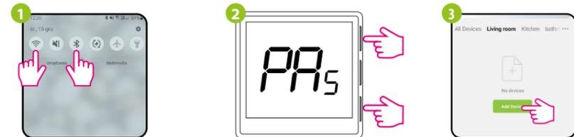
Vergewissern Sie sich auf Ihrem Mobilgerät, dass der ENGO Smart Zugriff auf Berechtigungen hat (Standort, Bluetooth, Geräte in der Nähe). Schalten Sie dann Bluetooth und Standort ein. Verbinden Sie sich mit dem 2,4-GHz-Wi-Fi-Netzwerk, dem Sie das Gerät zuweisen möchten.
