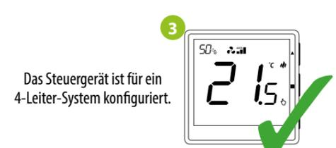
Das Steuergerät ist für ein 4-Leiter-System konfiguriert.
